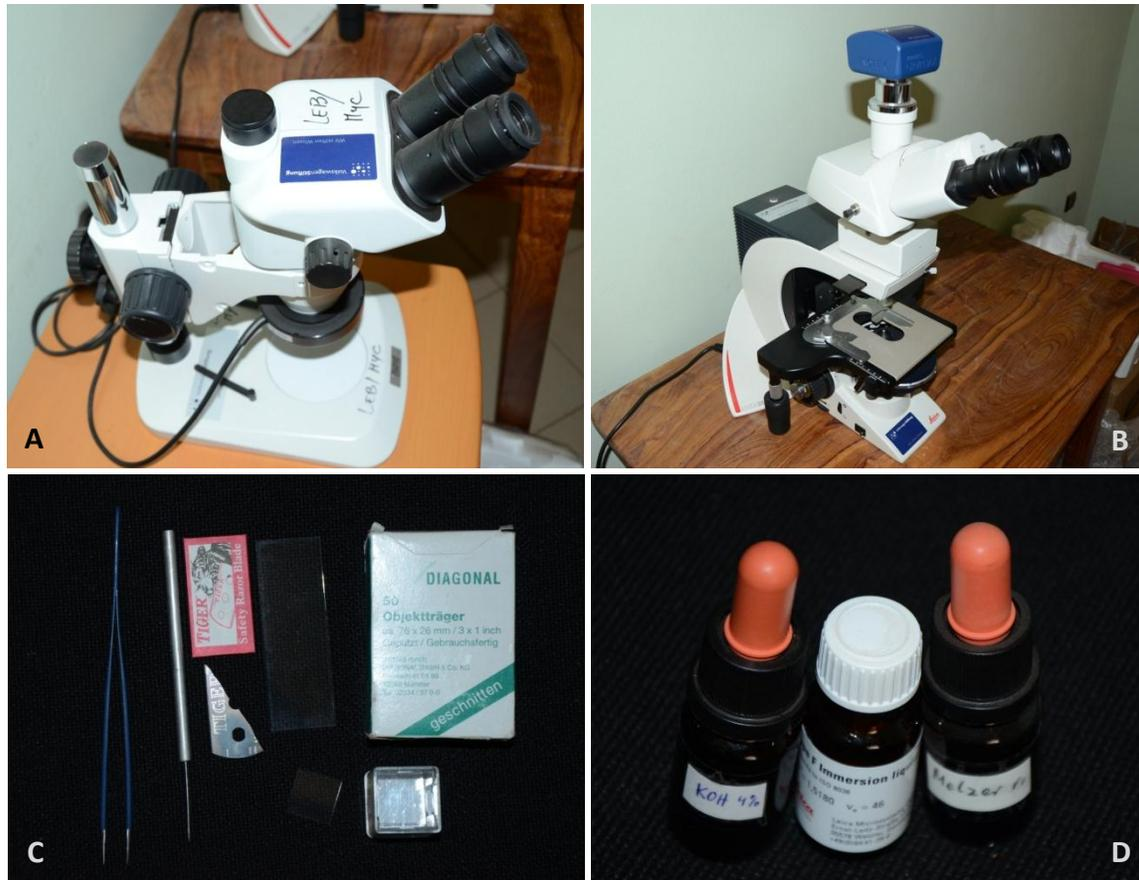
**Photo 11 :** Equipement et réactifs utilisés. A, Stéréomicroscope; B, Microscope ; C, équipement de dissection (pincette, aiguille montée et lame rasoir) et de montage de préparation (lame porte-objet et lame couvre-objet) ; D, réactifs (KOH 4%, Huile à immersion et Melzer).
