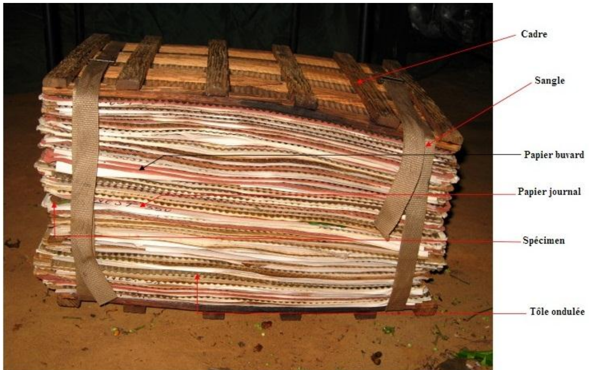
Figure 4 : Presse botanique contenant des spécimens prêts à être séchés. ( Source : adaptation de la version anglaise dans Ndolo Ebika 2010 : 12 ).
